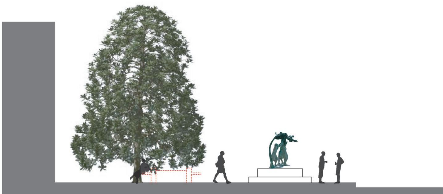
**157** sezione trasversale di Piazzetta Olivotti. Le aiuole esistenti (in rosso) vengono riportate a quota zero in modo da rendere lo spazio il più possibile continuo, recuperando i materiali esistenti.
